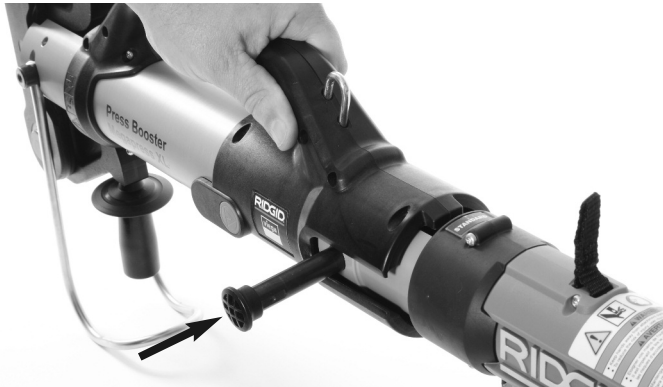
Figura 2 – Montaje del impulsor en la selladora
