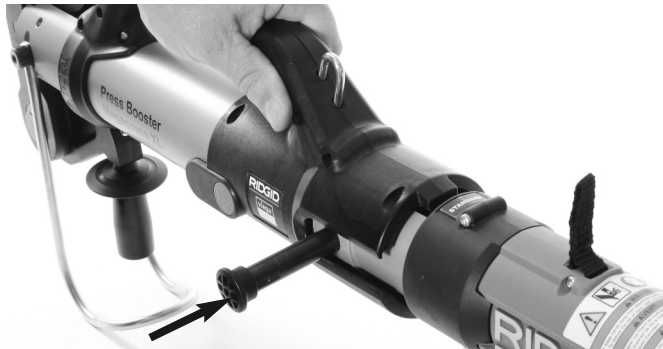
Figure 2 – Montage du Press Booster sur sertisseuse
